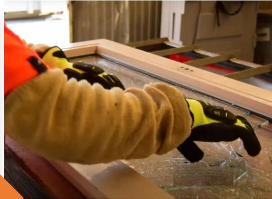
Les fenêtres sont démontées permettant d'extraire le verre plat de l'ossature (PVC, bois ou alu)
